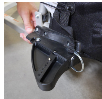
Schwarze Kunststoffdeichselaufnahme mit integriertem Radabweiser
