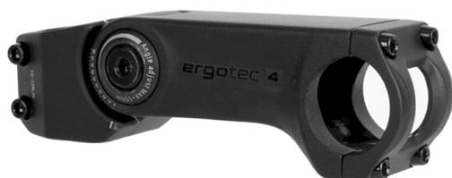
Stabiler, winkelverstellbarer Ahead-Vorbau. Die Form ist an die aktuellen Rahmenformen angepasst und verleiht auch dem Cockpit ein dazu passendes modernes Design. Safety Level: 5 Klemmhöhe 40mm, Winkel -0°/ +60° Gabel-/Klemmung: 28,6mm/31,8mm Gewicht: ca. 252g Material: AL 6061 T6
