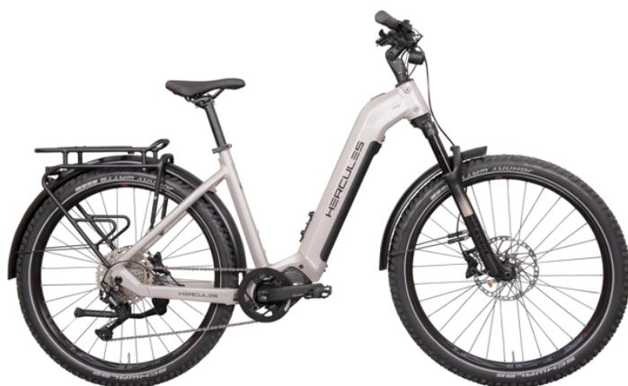
Mit der Basis eines E-Mountainbikes und der Ausstattung eines Trekkingrads ist das Nos SUV 2.2 ein kerniger Allrounder für Stadt und Gelände. Tägliche Pendlerstrecke oder anspruchsvolle Offroad-Tour - dank der Kombination aus dem genauso kraftvollen wie kompakten SHIMANO EP8-Antrieb und leistungsstarken Komponenten fühlt sich das HERCULES SUV überall zu Hause. Mit 85 Newtonmetern Drehmoment, einer
