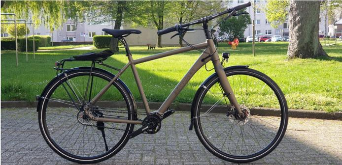
18 Gang Pinion Getriebe mit Gates Carbon Riemen
