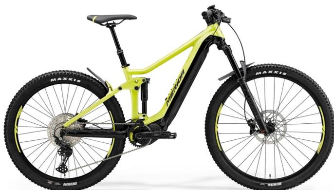
Ausgestattet mit dem neuen EP8 Motor von Shimano, der eine erhöhte Leistung von 85 Nm, weniger Gewicht, noch kompaktere Ausmaße und weniger Reibung bietet. Darüber hinaus glänzt der neue interne Akku mit 630 Wh durch eine größere Reichweite und superschnelle Ladefähigkeit. Erstmals 2015 bei unserem NINETY-SIX eingeführt, ist die neue Version unseres Lenkanschlags direkt in den Rahmen eingearbeitet. Im Fall eines Sturzes UVP: 5.399,00\*
