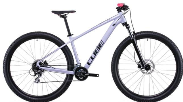
Power ist nichts ohne Kontrolle. Deshalb hat Cube das brandneue Access WS EAZ auch mit kräftigen, einfach zu bedienenden hydraulischen Scheibenbremsen ausgestattet, die das Bike zuverlässig und direkt verzögern, und zwar bei jedem Wetter und allen (Trail-)Bedingungen. Dazu gesellt sich der Komfort einer Suntour Federgabel, die auf ruppigen Strecken jede Unebenheit souverän glattbügelt. Und bei Anstiegen hat
