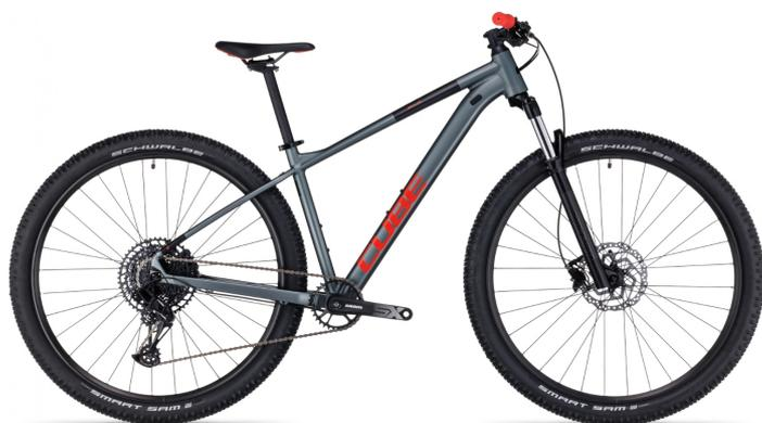
Ein Mountainbike-Hardtail ist ein super Allrounder und mit dem richtigen Set-up der absolute Ingegriff von Vielseitigkeit. Bei der Konfiguration des neuen Analog hat Cube deshalb eine SX Eagle 1x12 Schaltung von Sram verbaut: weiter Übersetzungsbereich, einfache Bedienung, zuverlässige Performance - perfekt für ambitionierte Trail-Fahrer. Dann haben sie ihm leistungsstarke hydraulische Shimano Scheibenbremsen
