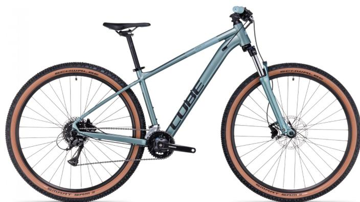
Der perfekt abgestimmte Mix aus Komfort und Performance: Mit dem Access WS Exc löst frau ihr Ticket für grenzenlose Zweiradabenteuer! Hier trifft eine leichtgängige 2x8-fach Schaltung mit weitem Übersetzungsbereich auf hydraulische Scheibenbremsen - beides von Shimano. Das Ergebnis: sensationeller, kraftsparender Support auf Anstiegen in Kombination mit direkter, superzuverlässiger Bremsleistung bei allen
