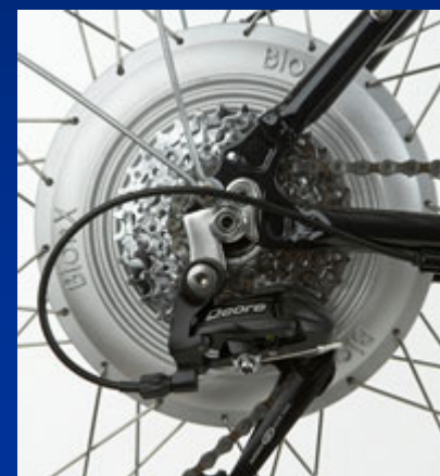
Extrem leistungsfähiger Pedelec-Antrieb mit Hinterradmotor
